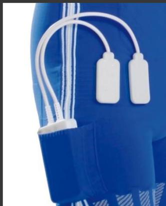
На время тренировки модуль Powerbox нужно вставить в предназначенный для этого карман на костюме MotionSkin. При этом нужно следить за правильной и надежной фиксацией модуля Powerbox, во избежание случайного выпадения модуля.
